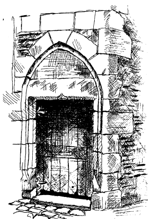
porte XVème : arc de décharge en tiers-point (1 clef, 2 voussoirs, 2 sommers), linteau droit avec feuillure
